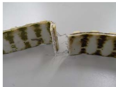
図9 タイミングベルトの破断状態
